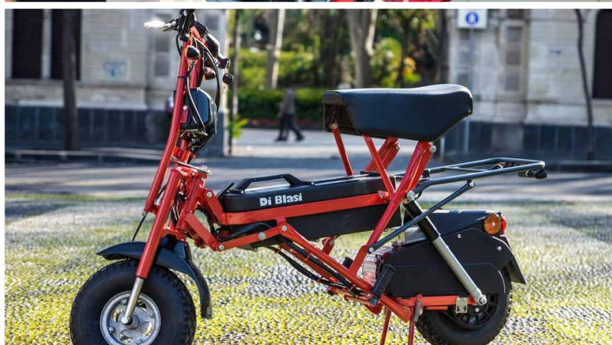
Lo **scooter pieghevole R70** è azionato da un motore elettrico alimentato da batteria a litio. **La velocità massima è di 40 km/h**; l'autonomia è di circa 50 km misurata in condizioni d'uso standard.
